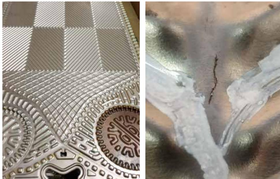
Sorgte für einen Einbruch der Wärmeproduktion durch Geothermie: Haarriss am Plattenwärmetauscher eines Verdichters der Geothermie-wärmepumpen.
