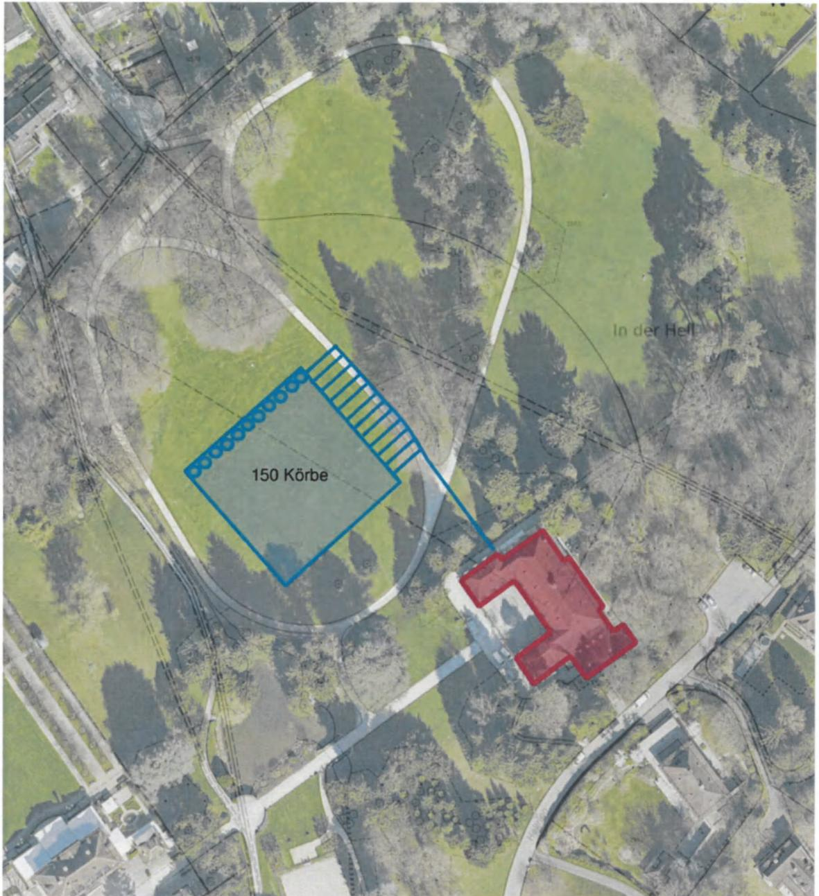
Bei der Verlegung der Erdkörbe wird die Rasenfläche von den Maschinen (Schneckenbohrer) und den Grabarbeiten für die Sondenleitungen beeinträchtigt. Ein Komplettersatz der Rasenfläche ist nach den Bauarbeiten unumgänglich. Während der Bohrarbeiten wird die Fläche eingezäunt (allenfalls mit ansprechend gestaltetem Sichtschutz), um die Besucher und den Arbeitsbereich klar abzutrennen.
