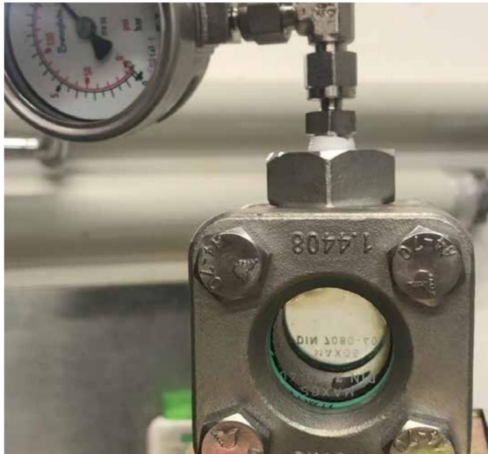
Wie bei einer Wasserflasche findet bei sinkendem Druck, hier bei 7,5 bar, eine Ausgasung statt.
